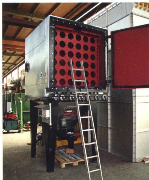
Пылеочистка соломосжигательной установки мощностью 600 кВт.
