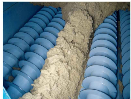
Шнеки для сбора пыли в бункере Deichmann
